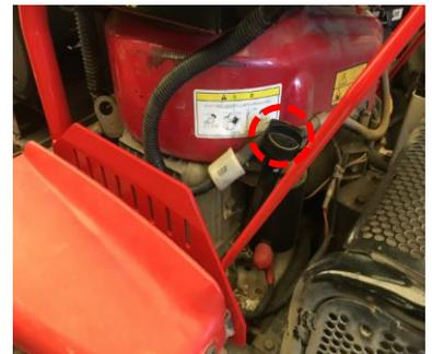
※プラスチック製のエンジンボンネットが付いている機種は、エンジンボンネットを手で開けて作業をしてください。鉄製のエンジンボンネットはマイナスドライバーなどで、固定ピンをはずすことで開けることができます。詳細は取扱説明書をご参照ください。
