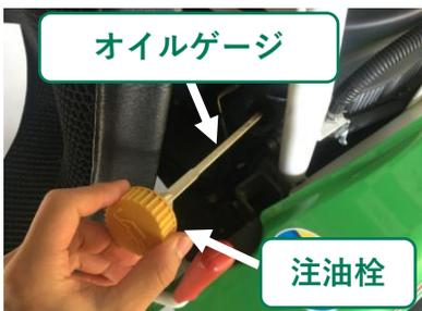
※エンジンメーカーによってオイル量を確認する際の、オイルゲージの差し込み方が異なる。
