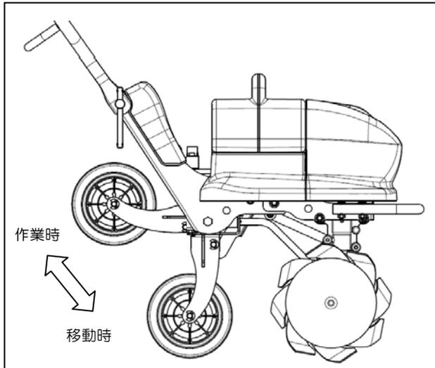
・移動車輪は圃場外で移動する際に使用します。移動車輪を使用して本機を移動させる際は、必ず電源スイッチを「切」にしてハンドルを上方に持ち上げ、抵抗棒を地表から浮かした状態で、車輪を靴底でロックするまで押し込んで下さい。
