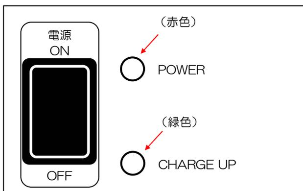
バッテリー充電器は左図及び下表に示す各 LED の点灯状態で充電状態を表示します。
