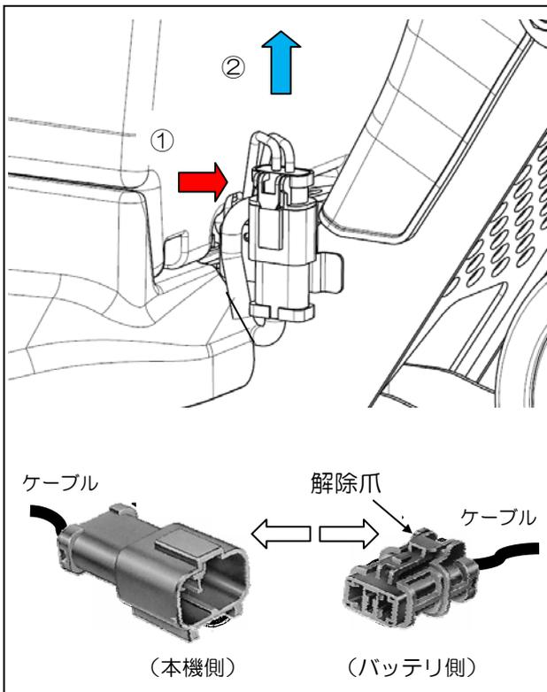
・バッテリーケース左後方に電源コードを接続するコネクタが見えるので、バッテリー側コネクタ先端の解除爪を押しながつまみ①、引き上げて切離して下さい②。
