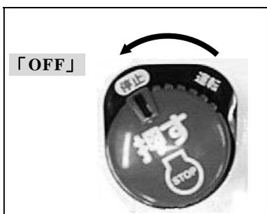
⑪エンジンスイッチを押して「**停止(OFF)**」位置にし、エンジンを停止して下さい。
