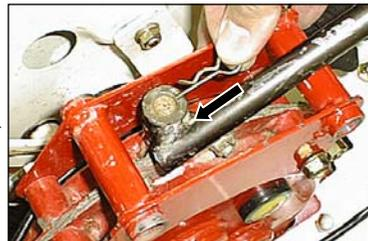
変速レバーを差し込み、Rピンで固定してください。
