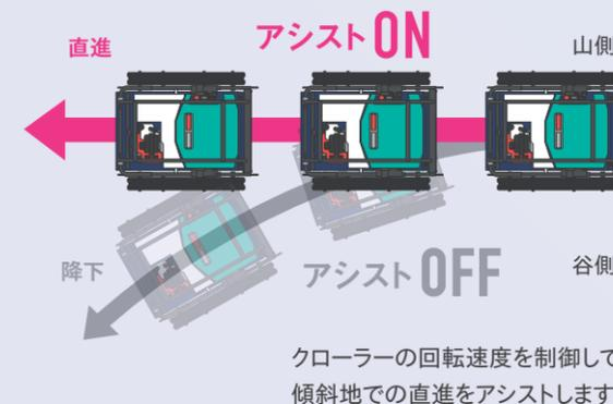
クローラーの回転速度を制御して傾斜地での直進をアシストします。
